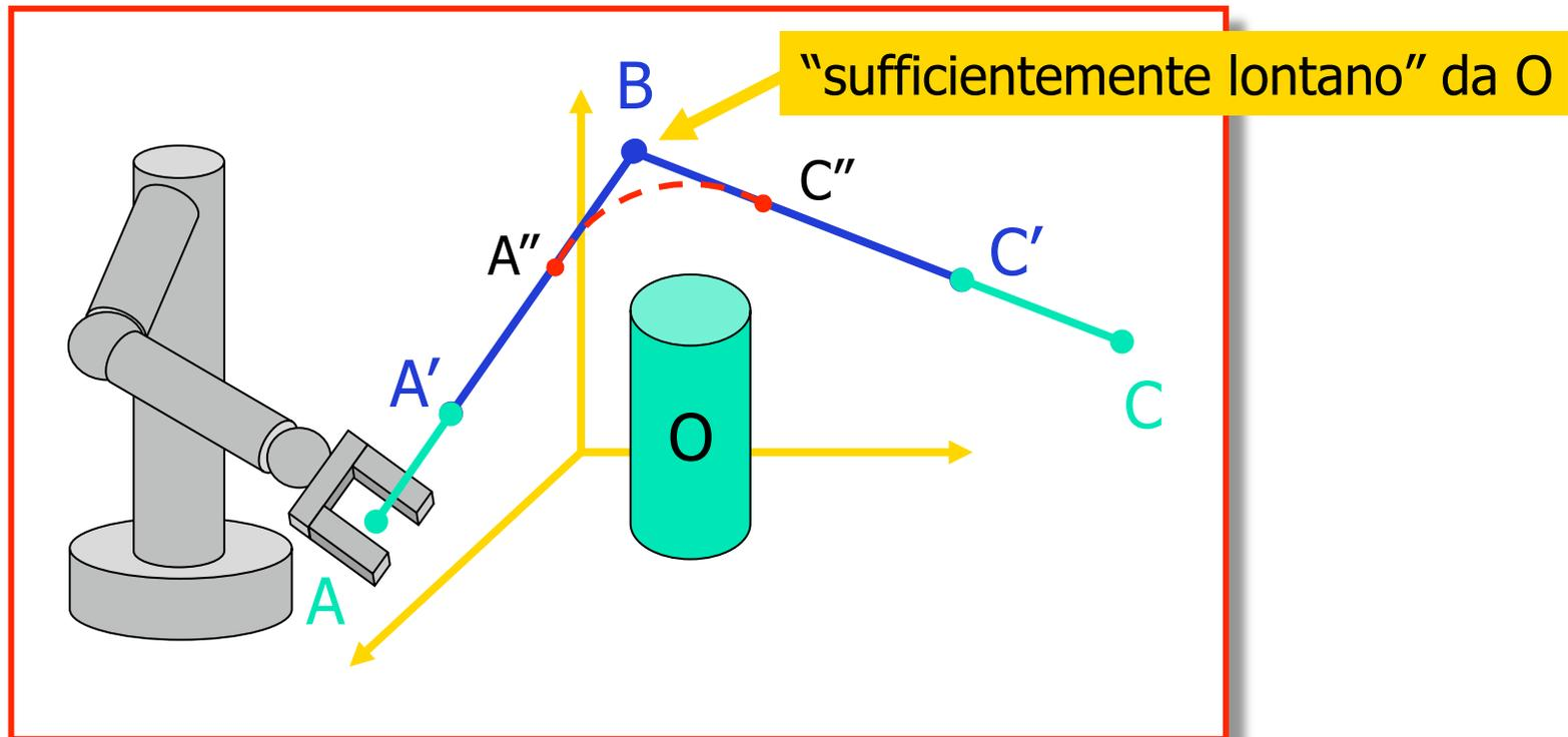
su  $\overline{AA'}$   $\rightarrow a_{\max}$ ; su  $\overline{A'B}$  e  $\overline{BC'}$   $\rightarrow v_{\max}$  su  $\overline{C'C}$   $\rightarrow -a_{\max}$
