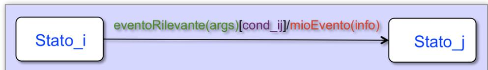
Progettazione del Software - Diagrammi degli stati e delle transizioni
