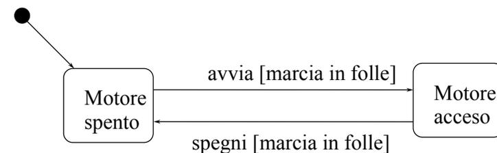
Progettazione del Software - Diagrammi degli stati e delle transizioni
