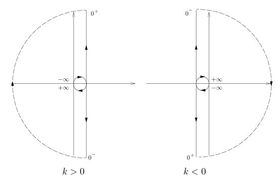
Se ne deduce che il sistema retroazionato è instabile per k > 0, è stabile asintoticamente per  $k^* < k < 0$ , ed è ancora instabile per  $k < k^*$ . Essendo inoltre il denominatore della funzione di trasferimento ad anello chiuso pari a
