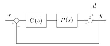
La prima specifica equivale a richiedere un sistema di tipo  $\geq 0$ , ed è quindi automaticamente soddisfatta se il sistema ad anello chiuso è stabile asintoticamente. Per quanto riguarda la seconda specifica, si osservi innanzitutto che per  $\omega=0$  il disturbo è costante; per avere astatismo in questo caso è dunque necessario introdurre nella funzione di trasferimento del controllore G(s) un polo nell'origine. Si pone allora
