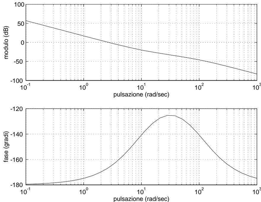
Poiché la compensazione deve fornire un'attenuazione di 17 dB e un anticipo di almeno  $34^\circ$  in  $\omega_t^* = 1$ , è necessario usare in modo combinato la funzione anticipatrice e quella attenuatrice.
