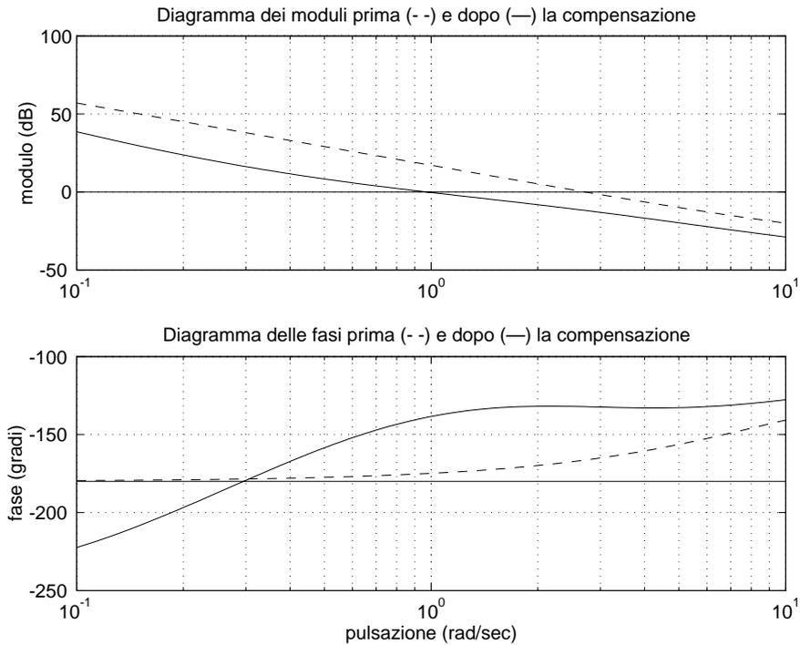
$\omega_t^* = 1$  un anticipo netto di  $45^\circ - 9^\circ = 36^\circ$  e un'attenuazione netta di  $7\text{dB} - 24\text{dB} = -17\text{dB}$ . L'effetto della compensazione è evidente nella figura successiva.
