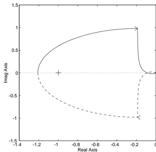
Poiché il diagramma effettua un giro in senso *orario* intorno al punto critico, il criterio di Nyquist indica che il sistema ad anello chiuso è instabile. Tuttavia, aumentando sufficientemente il valore di  $k$  il diagramma effettuerà un giro in senso *antiorario* intorno al punto critico: si avrà quindi stabilità asintotica ad anello chiuso. Per  $K < 0$ , il diagramma non effettua alcun giro intorno al punto critico, e il sistema è sempre instabile ad anello chiuso.
