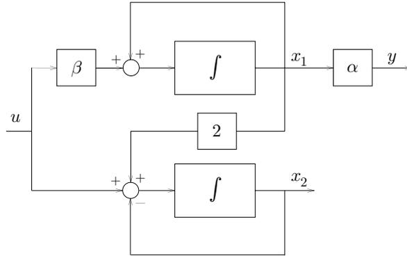
Utilizzando i metodi basati sullo spazio di stato, si stabilisca per quali valori di  $\alpha$  e di  $\beta$  è possibile costruire un controllore a retroazione dall'uscita tale che tutti gli autovalori del sistema ad anello chiuso valgano  $-1$ , e si determinino le equazioni di tale controllore. Infine, si determini la funzione di trasferimento del corrispondente compensatore dinamico.
