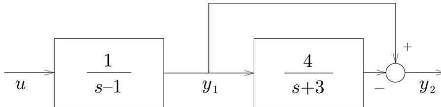
Supponendo che entrambe le grandezze  $y_1$  e  $y_2$  siano misurabili, si progetti uno schema di controllo a *dimensione complessiva unitaria* in grado di garantire la stabilità asintotica ad anello chiuso e la riproduzione asintoticamente esatta di segnali di riferimento costanti.
